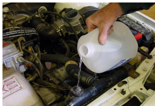
Gambar 1.4 penambahan etilen glikol pada air radiator agar terjadi penurunan titik beku
